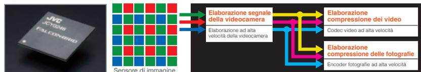
Circuito a banda larga di elaborazione del segnale della videocamera e circuito ad alta velocità di compressione dei video in un singolo chip.
