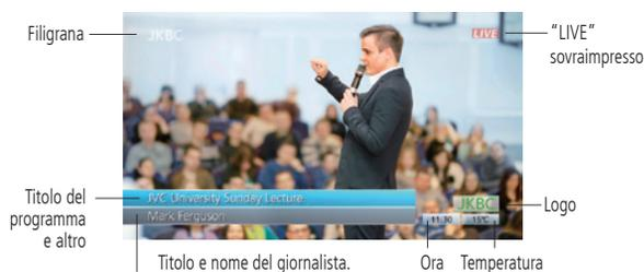
Progettata per essere utilizzata per trasmissioni Live Streaming, GY-HM250E permette la sovrainpressione di titoli, loghi, ecc. in tempo reale, così potrai trasmettere in diretta e registrare il tuo filmato senza il necessario utilizzo di un generatore di grafiche e di un mixer video. Gli overlay grafici del terzo inferiore vengono generati e controllati utilizzando un dispositivo dotato di browser, ad esempio un tablet.
