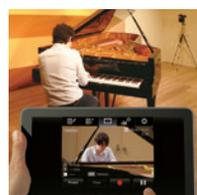
Quando la videocamera è connessa alla rete, tutti i parametri possono essere controllati a distanza, tramite PC, Tablet, Smartphone o RM-LP100 opzionale. Le funzioni di controllo remoto includono il controllo dell'ottica, il menù della videocamera, nonché le impostazioni di connessione IP.
